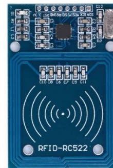
Fig. 5: MFRC522 RFID Module
